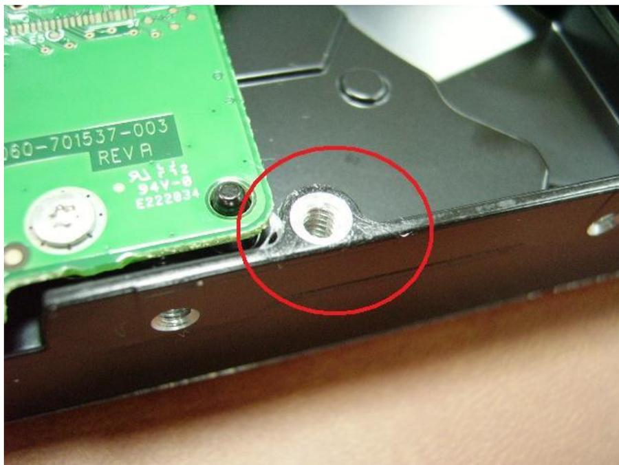
4. 將橡膠墊片放在四個螺絲孔上.
