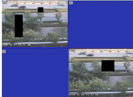
現場畫面遮罩區域
