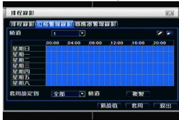
Fig 3-16 排程錄影-位移警報錄影
