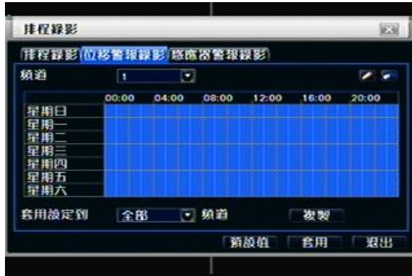
Fig 3-16 排程錄影-位移警報錄影
